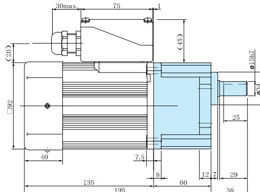
※适用橡皮绝缘软线的外径为  $\varphi 8 - \varphi 1.2$
