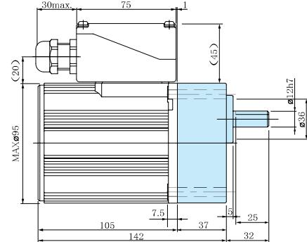
※适用橡皮绝缘软线的外径为  $\varphi 8 - \varphi 1.2$
