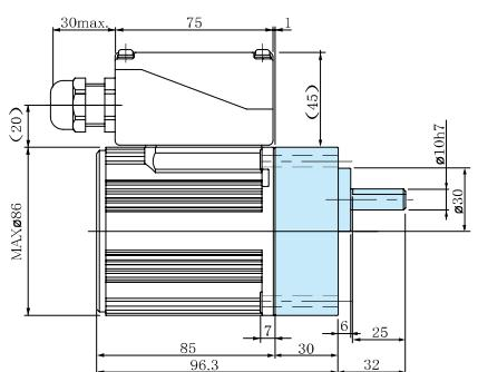
※适用橡皮绝缘软线的外径为φ8 - φ1.2
