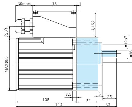
※适用橡皮绝缘软线的外径为φ8 - φ1.2
