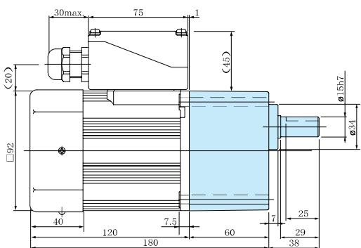
※适用橡皮绝缘软线的外径为φ8 - φ1.2
